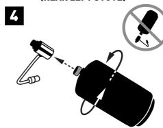
**CONNECT AND SECURE FUEL CYLINDER TO REGULATOR** IN UPRIGHT POSITION
