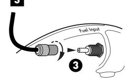
CONNECTER ET FIXER LE RÉGULATEUR À L'ORIFICE D'ENTRÉE DU CARBURANT. (CUISINIÈRE ARRIÈRE GAUCHE)
